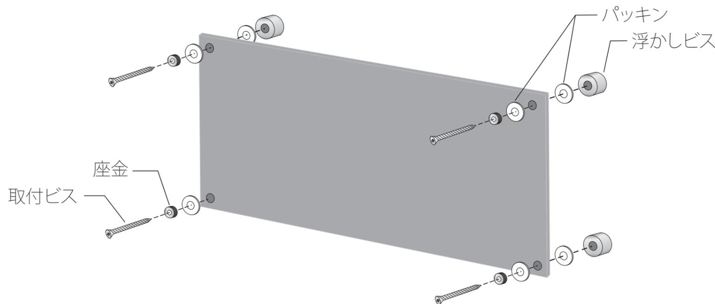
2. キャップを座金にねじ込みしっかり固定して完了です
