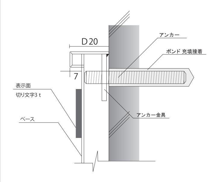
ベース:装飾枠付ステンレス箱曲げ(塗装) D20 表示方法:チタンゴールド鏡面仕上げ切り文字3 t
